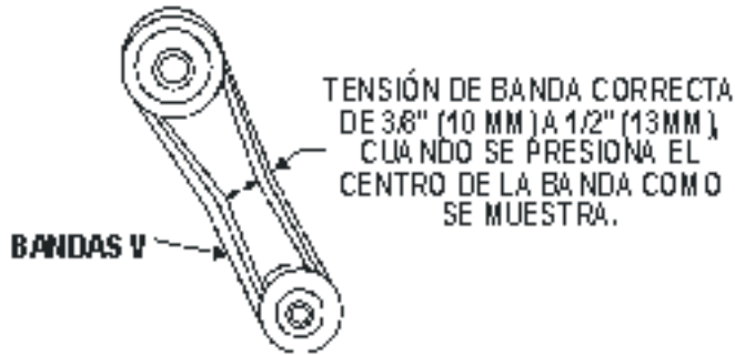
Figura 16. Tensión de las Bandas V
